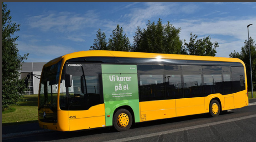
Takket være en ladeeffekt på 150 kW er batterierne på få timer tilstrækkeligt opladet til at klare eftermiddagsskiftet og fortsætte kørslen til langt ud på natten.
